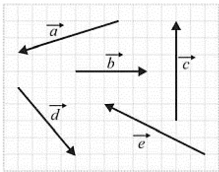
Considerando que um objeto pontual esteja submetido à ação dos cinco vetores força mostrados na figura precedente e que os lados de cada quadrícula da figura correspondam a uma unidade de medida, assinale a opção em que é representado corretamente o vetor força resultante.
